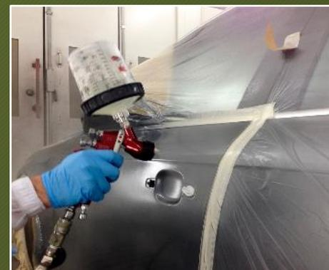
Las reglas especifican la eficiencia de transferencia mínima para reducir el exceso de pintura en aerosol y el residuos
