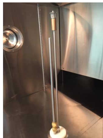
Figures 4d-e. Particle generators (d) and particle instruments inlet probes (e)
