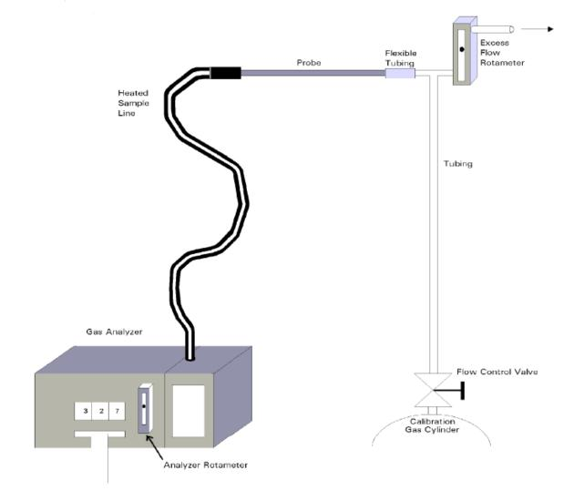
FIGURE 1. CALIBRATION SYSTEM SCHEMATIC
