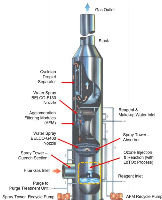
**Figure A-7. EDV<sup>®</sup> Scrubber with LoTOx<sup>™</sup> NOx Control<sup>3</sup>**
