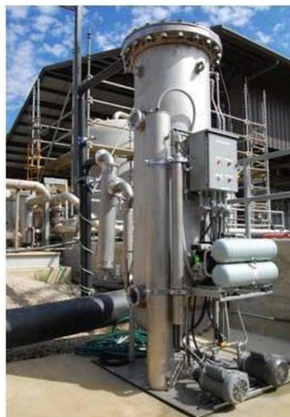
*Figure 6. Nrgtek 100-SCFM Siloxane Removal System*
