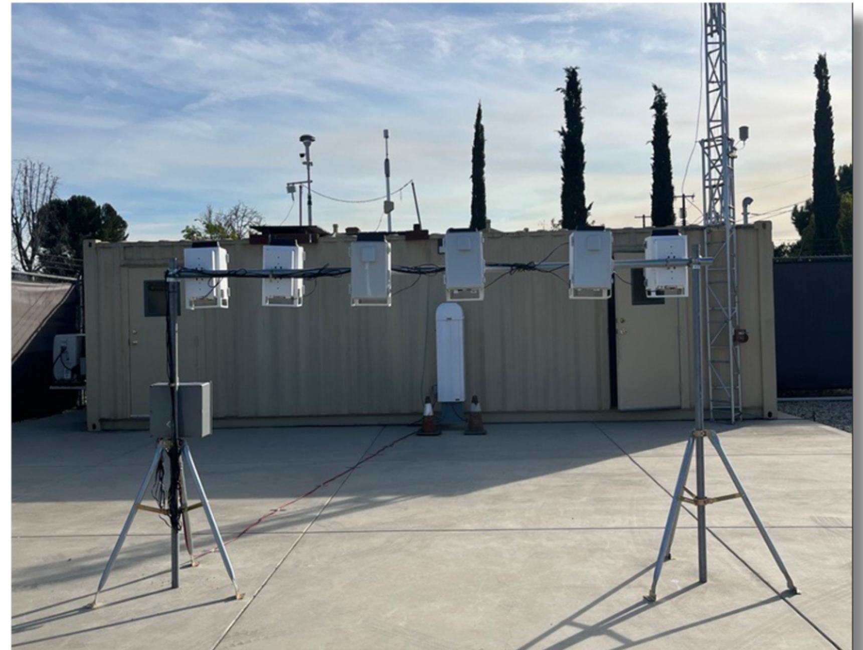
Air sensors undergoing collocation calibration for a community monitoring project Sensores de calidad del aire sometidos a calibración por colocación conjunta para un proyecto de monitoreo comunitario
