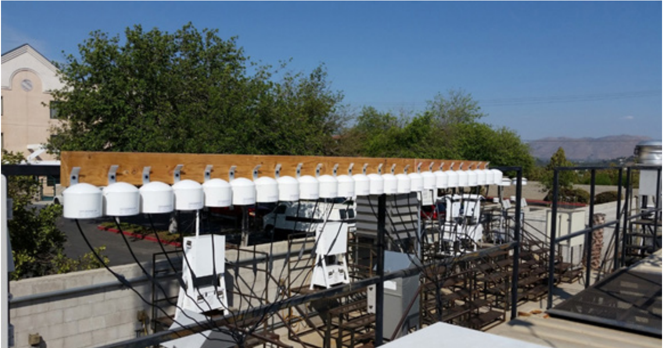
Figura 4-3. Sensores PurpleAir PA-II colocalizados con monitores regulatorios en la estación de monitoreo ambiental del South Coast AQMD en Rubidoux, California
