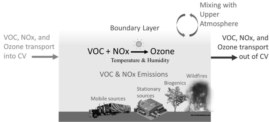
VOC (por sus siglas en inglés) = Compuestos orgánicos volátiles; NOx = Óxidos de nitrógeno
