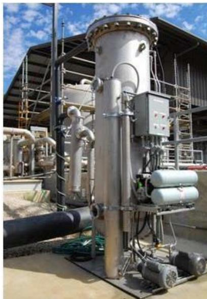
*Figure 6. Nrgtek 100-SCFM Siloxane Removal System*
